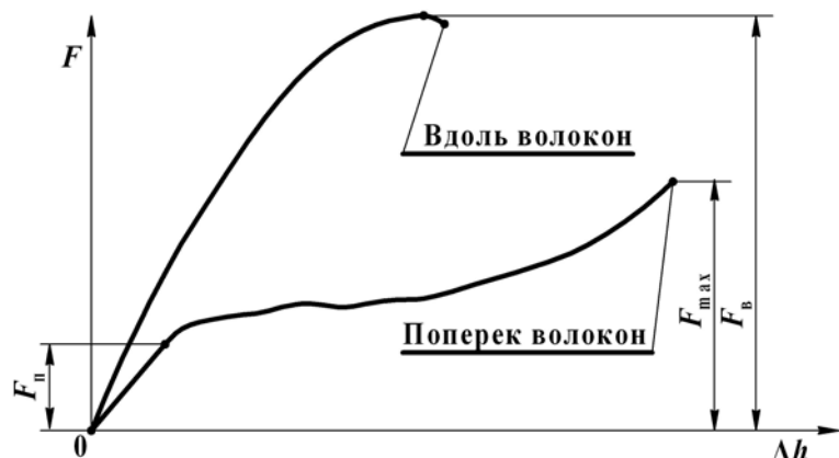
Рис. 5. Диаграмма сжатия деревянных образцов
